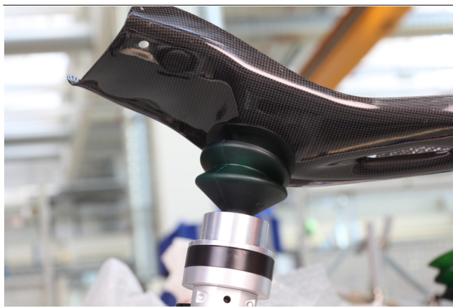
Uni-Base UB y ventosa de referencia RSC fijando un componente de PRFC
